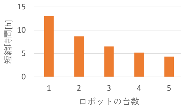
図4 最大物量におけるロボット台数と1台当たりの短縮時間の関係
